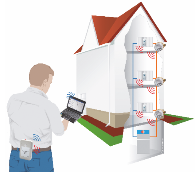
System zur drahtlosen Zählerfernauslesung ohne Betreten der Wohnungen
